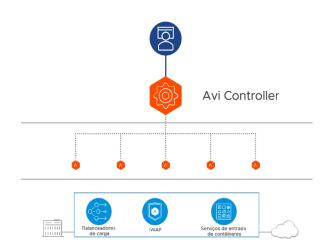
Os balanceadores de carga (ADCs) legados exigem posicionamentos VIP manuais, bem como gerenciamento de pontos de controle individuais. O NSX Advanced Load Balancer separa os caminhos de dados e as camadas de controle para promover serviços de aplicativos e balanceamento de carga de próxima geração.
